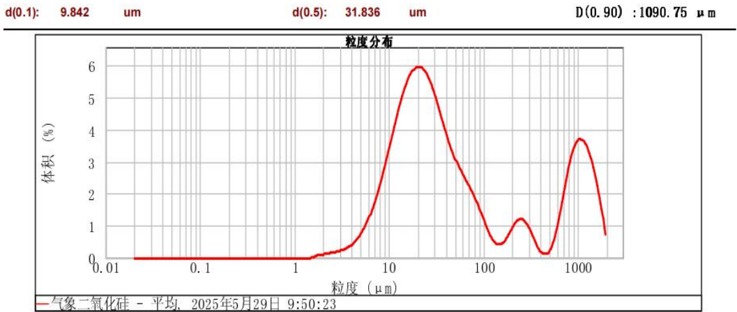
图 5 II 类产品长时间超声测量 D 50 粒度分布情况
