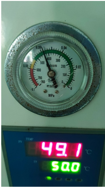
真空干燥温度（50℃）、压力（0.058Mpa）
