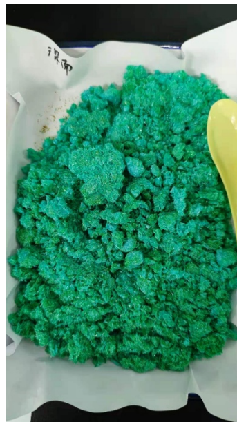
真空干燥后 (团块, 局部泛黄, 底部衬纸出现黄斑)
