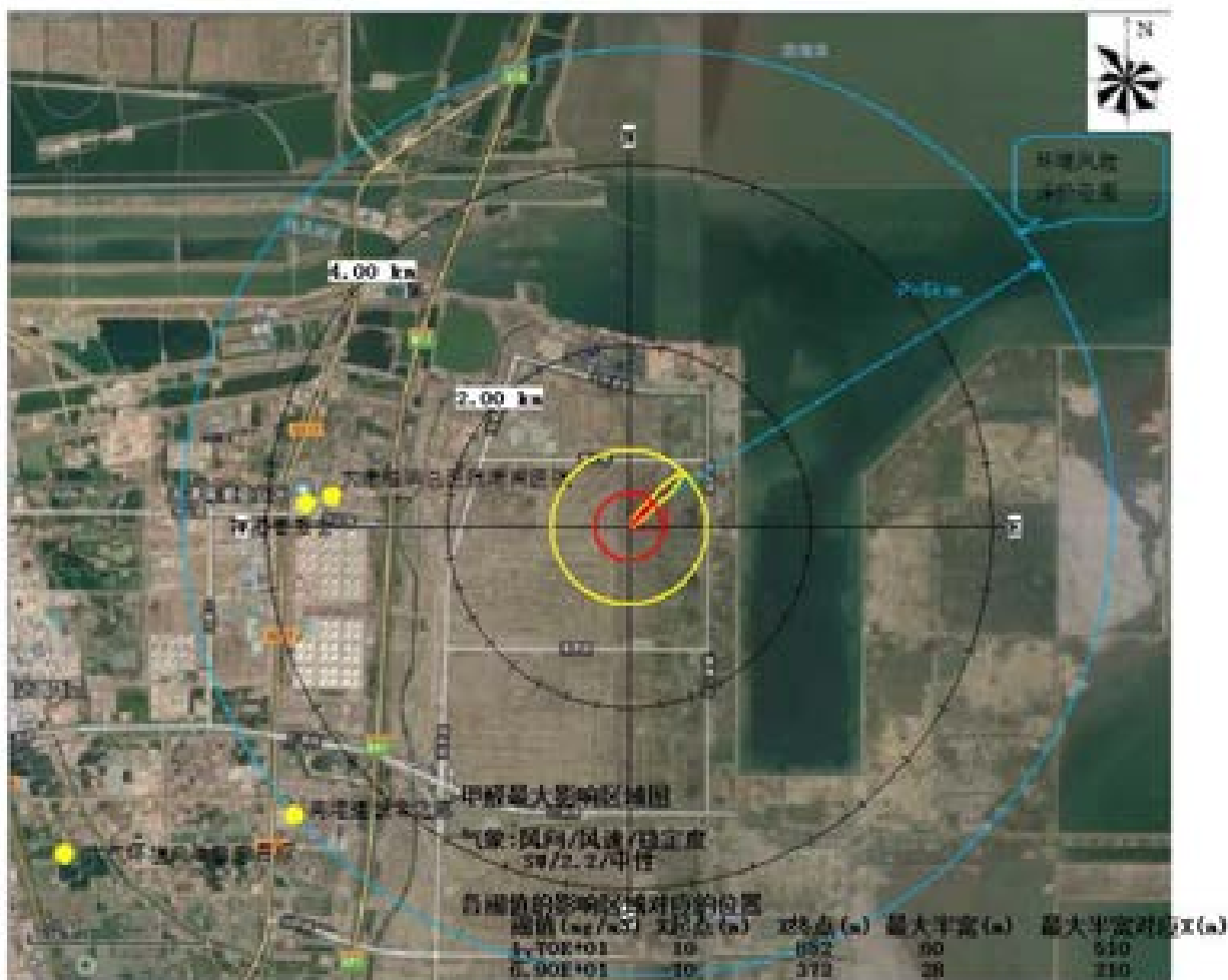
图 5.7-13 最常见气象条件 A 大气毒性终点浓度的影响区域分布图
