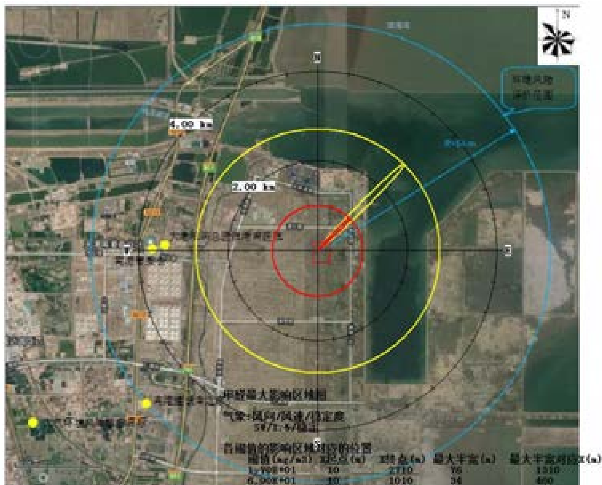
图 5.7-12 最不利气象条件下 A 大气毒性终点浓度的影响区域分布图
